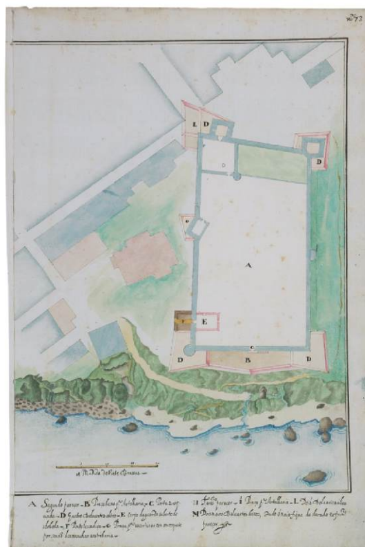
Fig. 7 Proposta de Alexandre Massai para abaluartar os quatro ângulos do castelo e fazer uma praça mais baixa para artilharia entre os baluartes do lado do mar. Apresenta também o fossete, a ponte levadiça e a casa da guarda. O fossete era uma versão simplificada do habitual fosso, pois a existência de casario, mormente a igreja, mais não permitia. Neste desenho o engenheiro representou ainda outra proposta, com a construção de meios baluartes. Fonte: MC, Alexandre Massai, 1621, fl. 73
