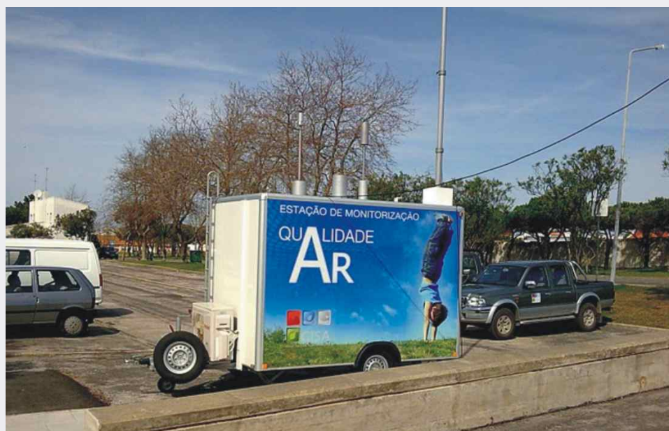
Estação móvel de monitorização da qualidade do ar no Bairro 1.º de Maio, em Sines
